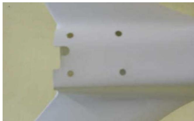
テールミッションをテールミッションホルダーと分離した状態でボディ後部を被せ、テールミッションを組み戻して下さい。
