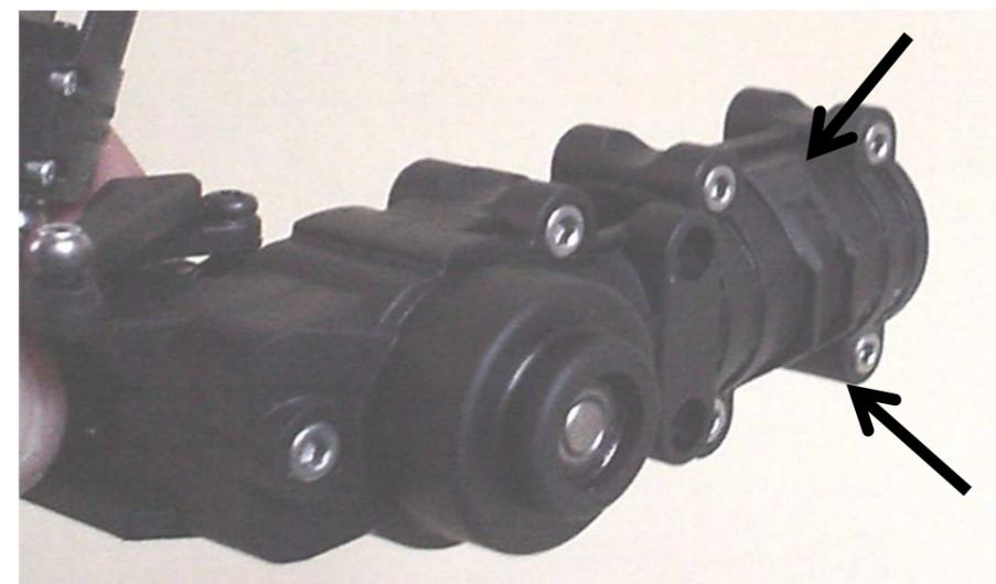
ボディ内面への接触を回避するため、テールギヤボックスの垂直尾翼取り付け台座の凸部を切除して下さい。
