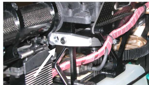
写真に示す位置に、ボディステーを取付けてください。
