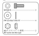
EX SWMエレベーターステーの下側 のクロスメンバーM3X26を取外し、 取外したM3X8CSとFW ø2.6Xø7.5X 0.5Tを使用し、M3ナイロンナッ 薄型で取付けます。
