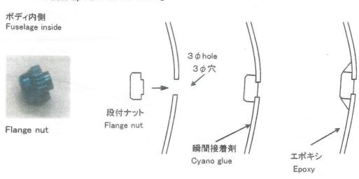
ボディ後部の3mm穴12個に、段付きナットを内側からはめ込みます。 外周部から少量の瞬間接着剤で固定し、周囲をエポキシ接着剤で固めます。 ボルト穴に接着剤を入れないよう注意してください。
