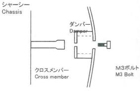
ボディにあけた60穴の外側からクロスメンバーを差し込んで下さい。 クロスメンバーにダンパーを仮組みして下さい。 スポンジ表面に瞬間接着剤を塗布した後、クロスメンバーを引っ張り出 し、ダンパーをボディ内面に接着してください。
