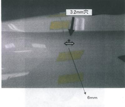
ボディ後部にナットの接着 Paste up nuts on the fuselage rear.
